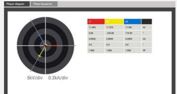
Diagrama vectorial para controlar conexiones.
